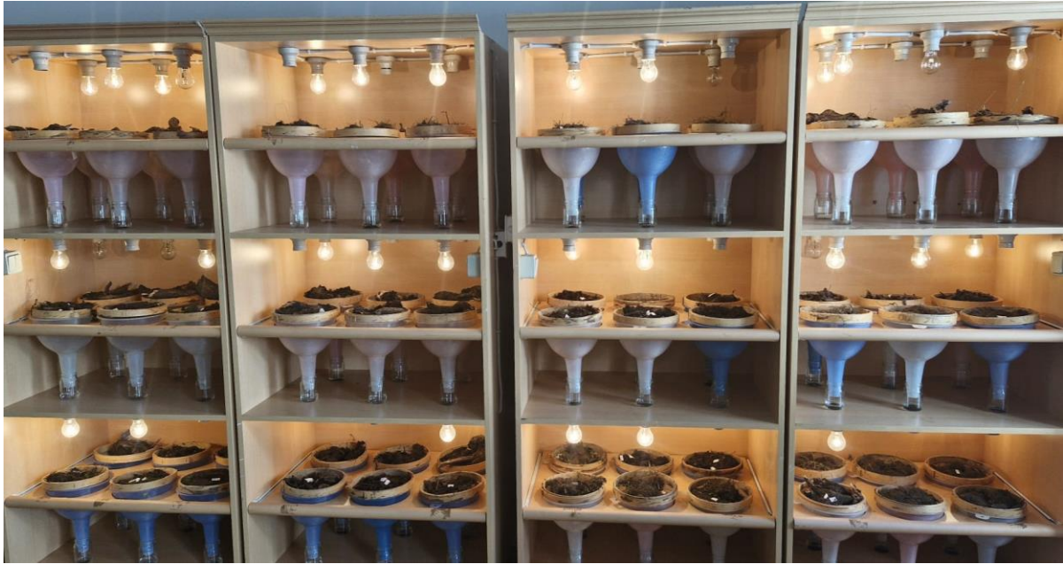
Şekil 3. Birleştirilmiş Berlese-Tullgren düzeneği
