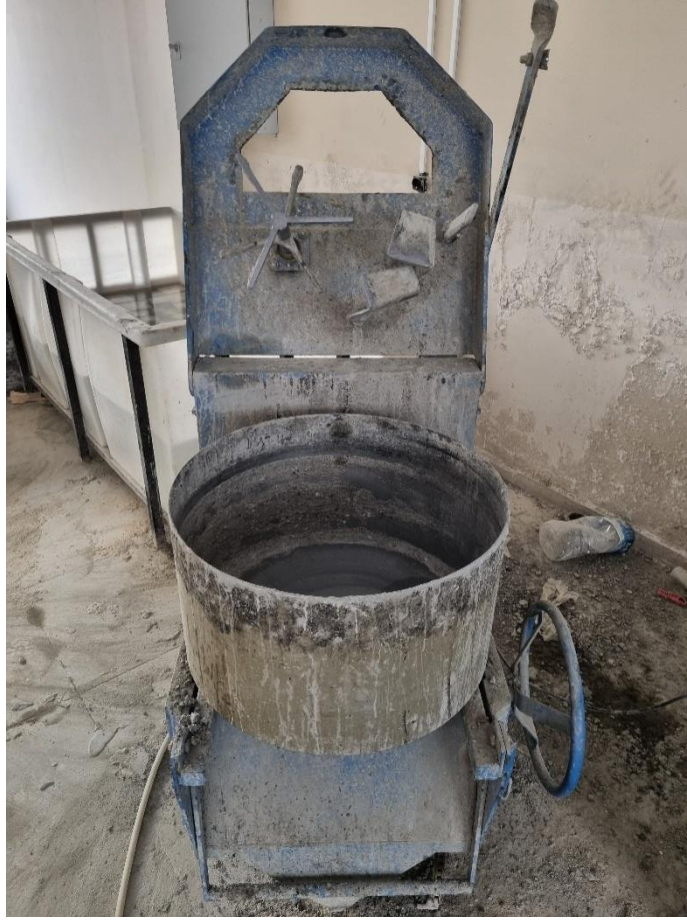
Şekil 8. Hafif beton üretimlerinde kullanılan mikser
