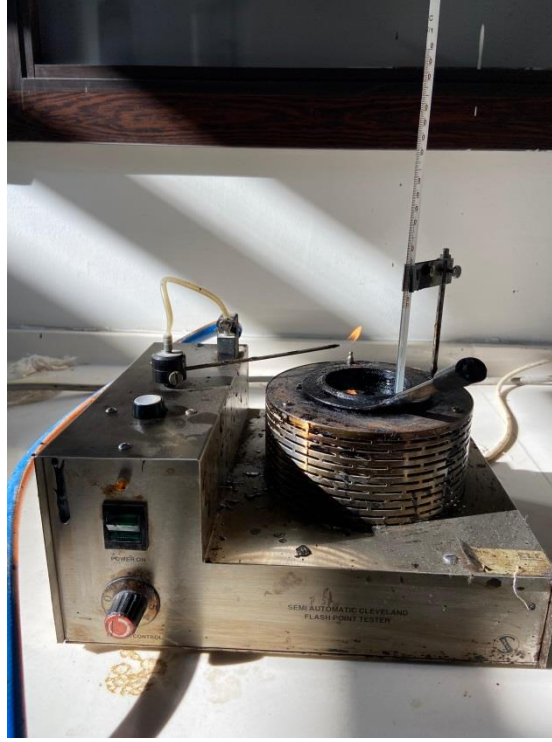
Şekil 3.19. Parlama noktası deneyinin yapılışı
