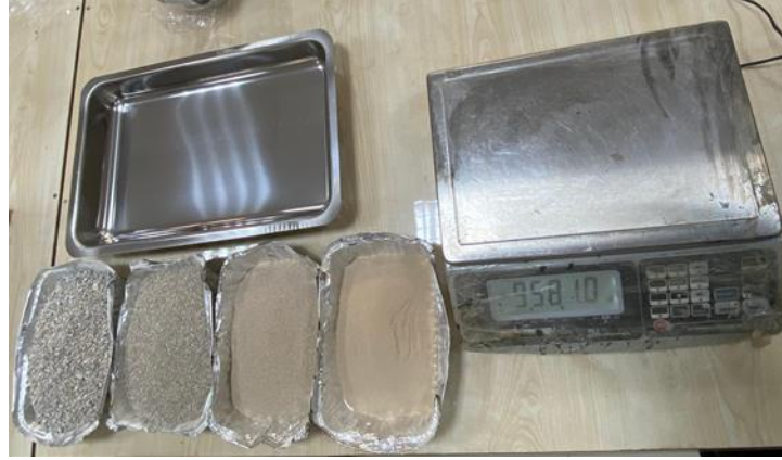
Şekil 3.20. Agrega karışımlarının hazırlanma aşaması
