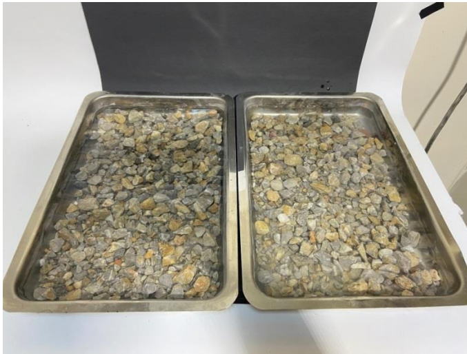
Şekil 3.5. 24 saat su içinde bekletilmiş agregalar
