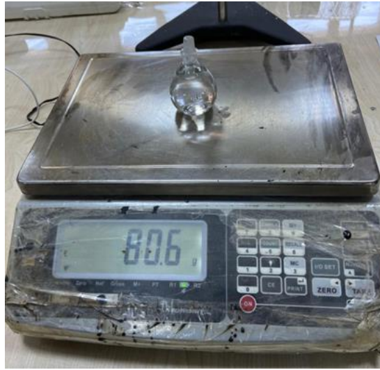
Şekil 3.1. Su doldurulmuş piknometrenin tartımı
