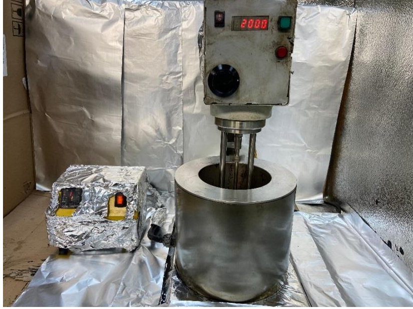
Şekil 3.11. Kendinden ısıtıcılı High Shear Mikser
