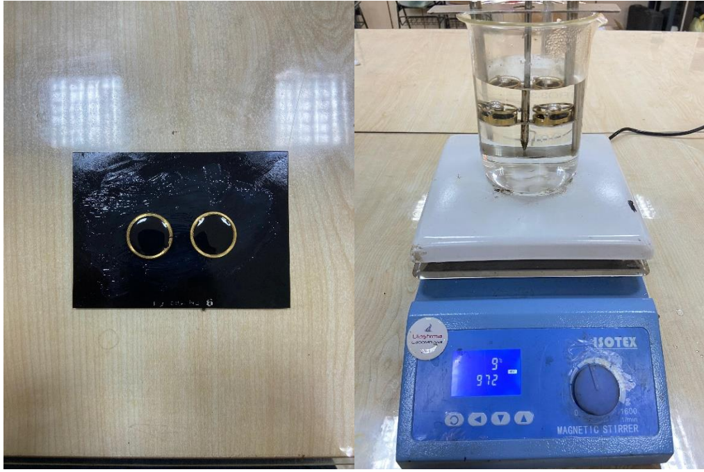
Şekil 3.13. Oda sıcaklığında bekleyen numuneler Şekil 3.14. Yumuşama Deneyi Cihazı
