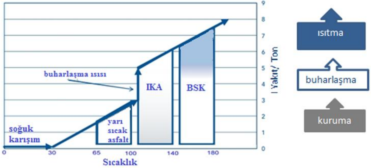
Şekil 2.10. Karışımların üretim sıcaklıklarına göre sınıflandırılması (D'Angelo ve ark., 2008).
