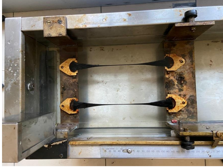
Şekil 3.17. Düktilite cihazına yerleştirilmiş numune
