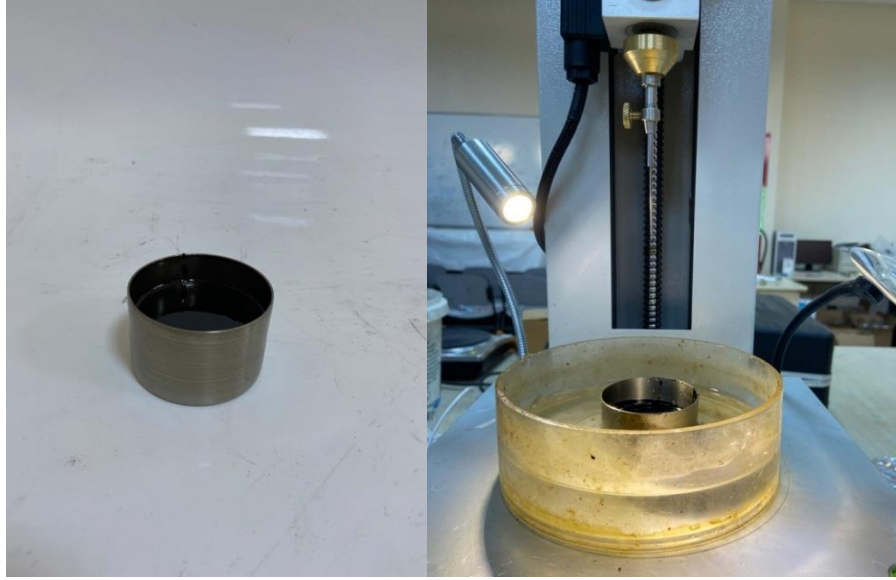
a) Oda sıcaklığında bekletilmiş numune b) Penetrasyon deney cihazı Şekil 3.12. Penetrasyon testi
