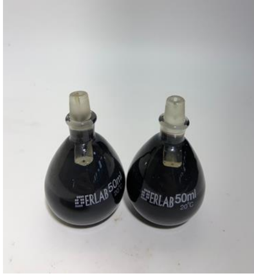
Şekil 3.2. Bitüm ve su doldurulmuş piknometreler
