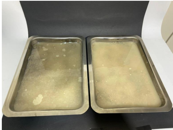
Şekil 3.7. 24 saat su içinde bekletilmiş agregalar
