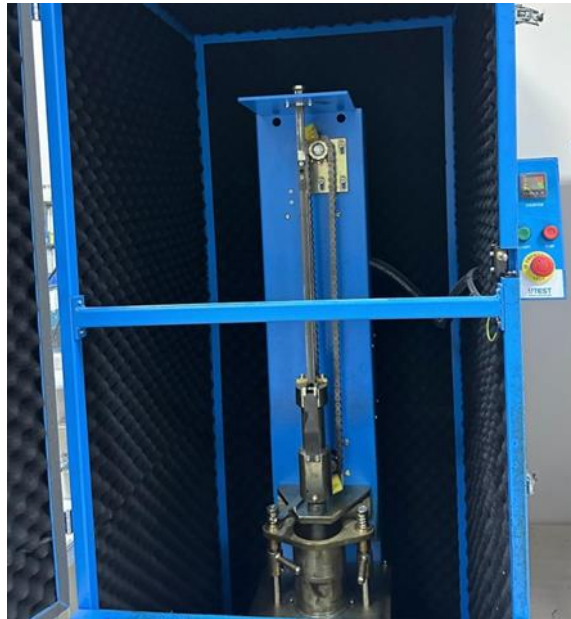
Şekil 3.22. Sıkıştırma tokmağı kullanımı
