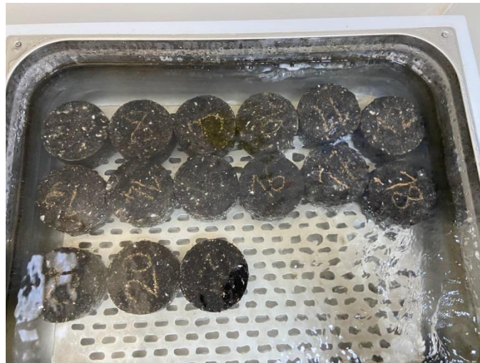
Şekil 3.25. Su banyosuna bırakılan briketler
