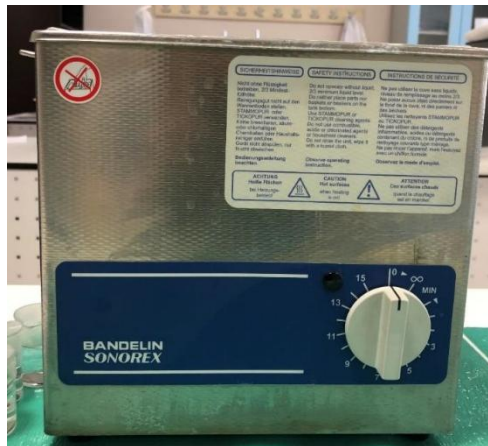
Şekil 2. Taban malzemelerinin temizlenme sürecinde kullanılan ultrasonik banyo cihazına ait bir görsel.
