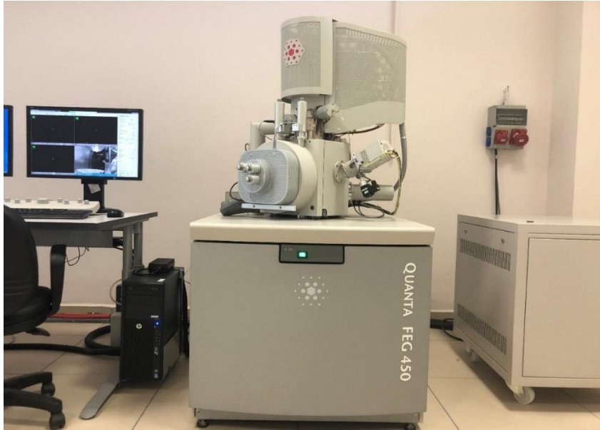
Şekil 13. Numunelerin yüzey morfolojisinin incelenmesi için kullanılmış olan taramalı elektron mikroskopuna ait bir görsel.
