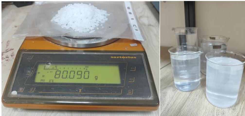
Şekil 13. Pul formundaki sodyum hidroksitin tartılması ve suya karışımı
