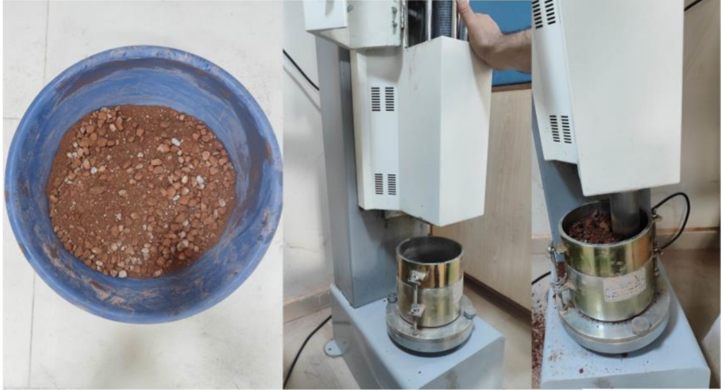
Şekil 15. Numune hazırlanması ve Modifiye Proktor cihazı
