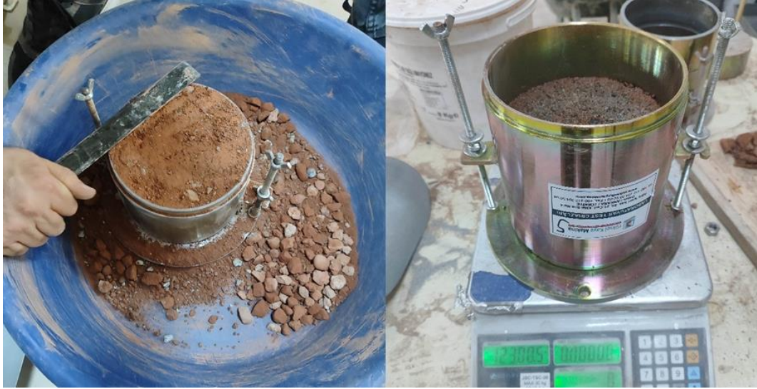
Şekil 16. Numunenin tıraşlanması ve tartılması
