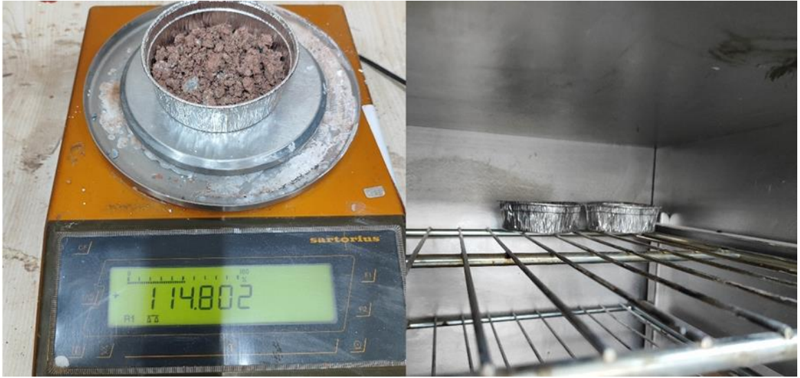
Şekil 17. Örnek alınan numunenin tartılması ve etüve gönderilmesi
