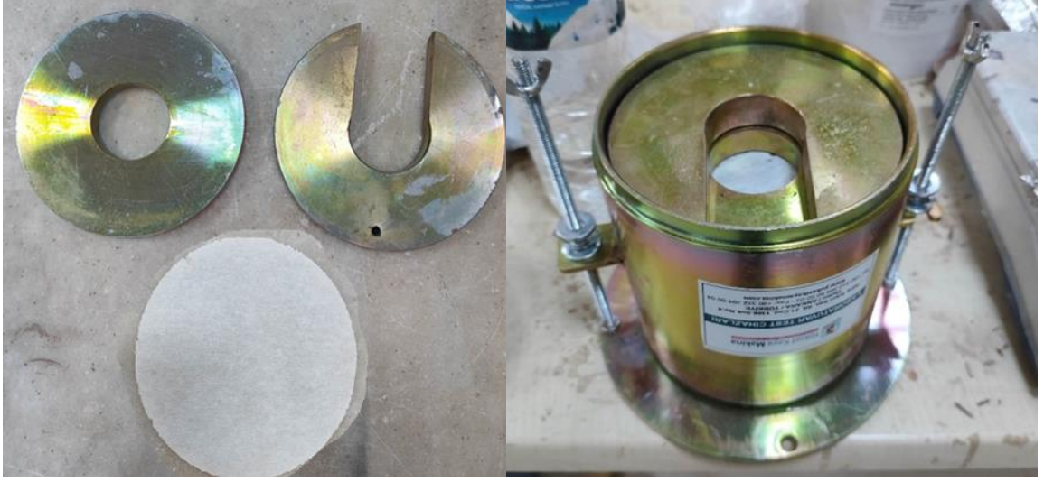
Şekil 18. Ara yükleme diski, yarıklı sürsaj ağırlığı, filtre kağıdının kalıba yerleştirilmesi
