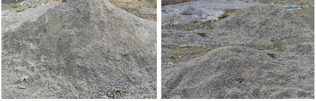
Şekil 8. Kırıcılar ile elde edilen agregalar
