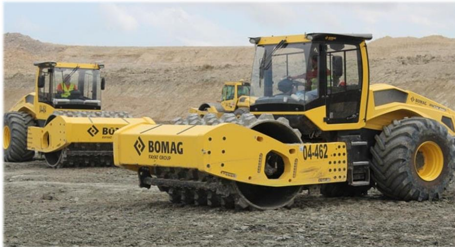
Şekil 2.4: Yüzey kompaksiyon yönteminden keçi ayaklı silindir ( www.sanalşantiye.com )
