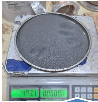
Numune etüv sonrası tartılır
