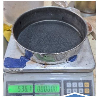
200 nolu elek üzerinde kalan numune etüv sonrası tartılır
