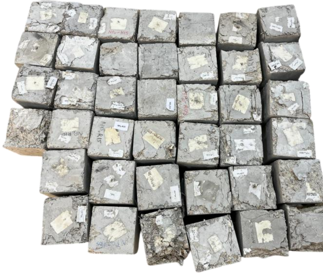
Şekil 22. Farklı perlit ve lif içeriğine sahip numunelerde gözlenen hasar dağılımları
