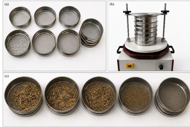
Şekil 10. Kenevir kırıtlarının tane boyutuna göre sınıflandırılması amacıyla gerçekleştirilen elek analizi işlemi: (a) kullanılan elek seti, (b) titreşimli elek cihazı, (c) elek analizi sonucunda elde edilen farklı boyutlardaki kenevir kırıtları fraksiyonları.
