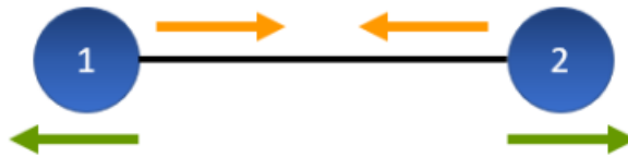
Şekil 10. İki atomlu bir molekülün bağ gerilmesi titreşimleri
