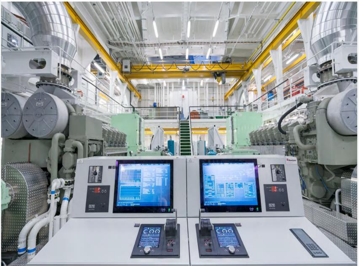
Şekil 12 Gemi elektrikselsel enerji yönetim sistemi [URL-3 Alewijnse]
