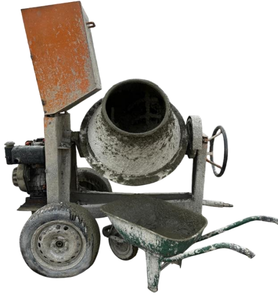
Şekil 3.16. Beton Karıştırıcı- Betonyer
