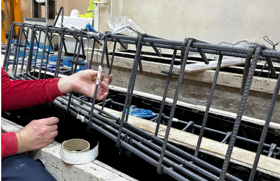
Şekil 3.13. Strain-Gauge Yapıştırılma İşlemleri
