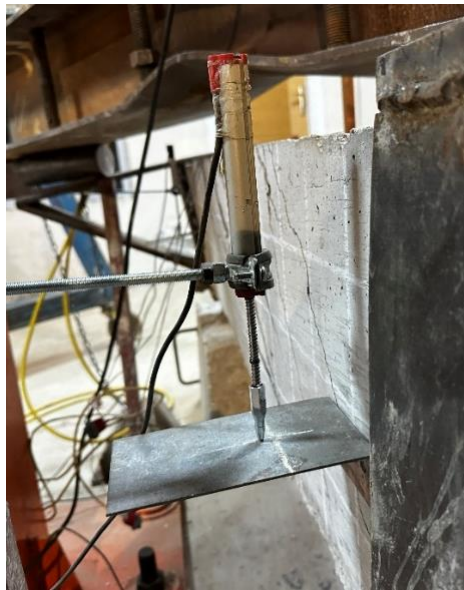
Şekil 3.23. Potansiyometrik Cetvel ve Levha
