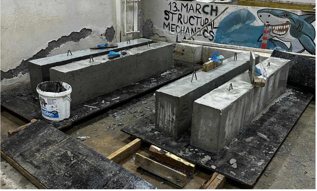
Şekil 3.18. Kalıpları Açılan Kiriş Numuneleri Kürleme İşlemleri
