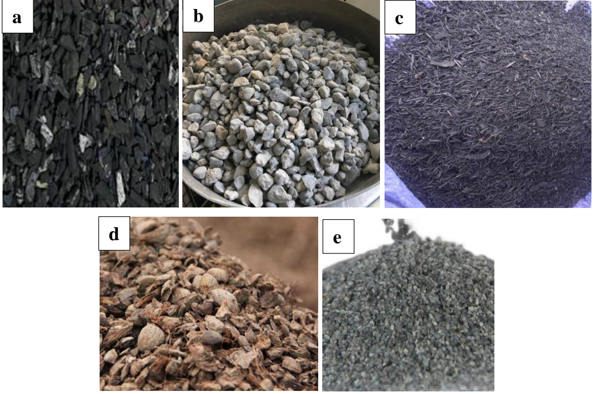
Şekil 1.4. a) E-Atık (Bulut ve diğ, 2024), b) Geri Dönüştürülmüş Agregat (Akkaya ve diğ, 2024), c) Kauçuk (Muhaimin ve diğ, 2015), d) Palmiye Kabuğu (Purwanti ve diğ, 2018), e) Doğal Perlit (Korkmaz ve diğ, 2024)
