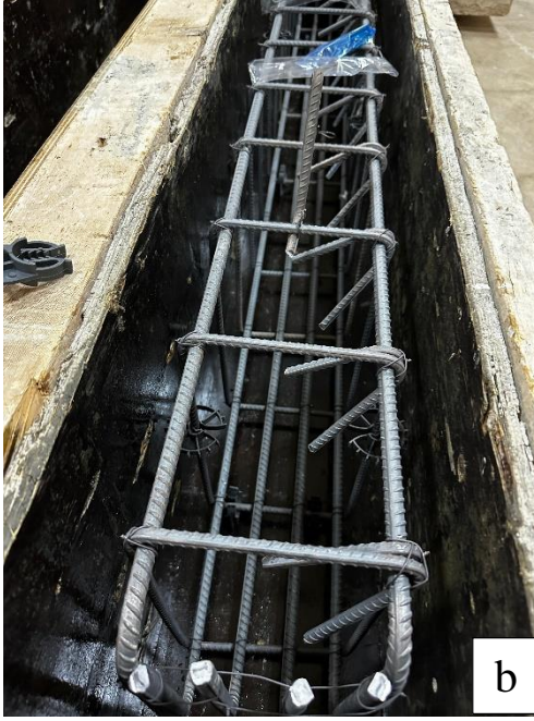
Şekil 3.15. a) Kalıp İçlerinin Temizlenip Yağlanma İşlemleri, a1) Kalıp Yağı, b) Donatı Kafesine Paspaylarının Takılıp, Kalıp İçine Koyulması İşlemi, b1) Deneyde Kullanılan 35mm'lik Paspayları
