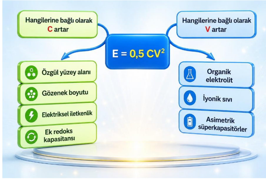
Şekil 15. Süperkapasitörlerde enerji yoğunluğunu belirleyen temel parametreler ve enerji yoğunluğunun artırılmasına yönelik başlıca stratejilerin şematik gösterimi.
