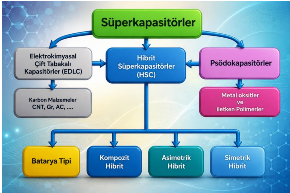
Şekil 11. Süperkapasitörlerin yük depolama mekanizmalarına göre sınıflandırılması.
