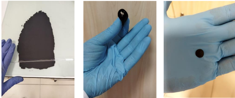
Şekil 32. Kâğıt formunda aktif karbon elektrot.
