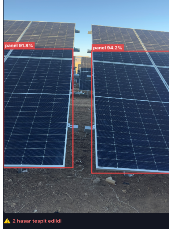
Şekil 8. Otonom Gölge Analizi ve Etkilenen Bölge Tespiti Çıktısı.
