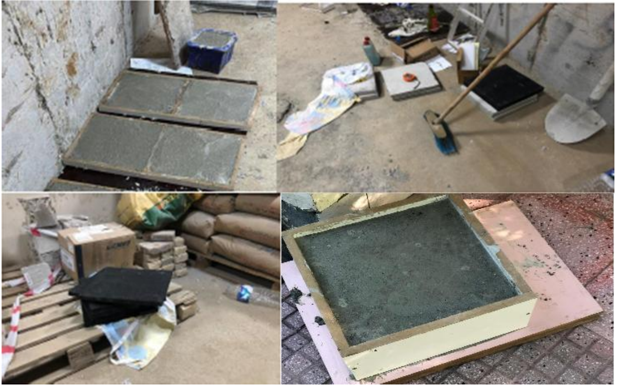
Şekil 9. Deney numuneleri, a.) ve d.) beton dökümü kür aşaması b.) kür sonrası test numune hazırlama öncesi c.) kauçuk istenilen boyutta kesim sonrası
