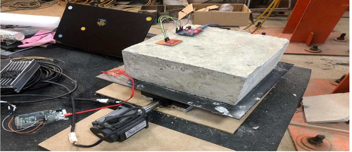
Şekil 13. Geleneksel temel, beton bloktan oluşmaktadır. Servo motor, kontrol ünitesi ve ivmeölçerin bilgisayara bağlantı düzeneği
