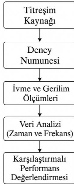
Şekil 17. Deneysel süreçte elde edilen titreşim kaynaklı ivme verilerinin analizine ilişkin genel veri değerlendirme akış şeması.
