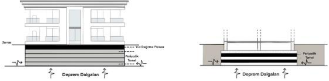
Şekil 1. Periyodik temel sisteminin prensip şeması. Soldaki modelde geleneksel temele sahip yapılarda deprem dalgalarının doğrudan yapı tabanına iletildiği görülmektedir. Sağda ise periyodik temel sisteminde, fononik kristaller aracılığıyla oluşturulan bant boşlukları sayesinde belirli frekanslardaki dalgaların yayılımı engellenerek yapı içerisine iletilmeden sönmüldüğü ifade edilmektedir (Kushwaha ve diğ., 1993; Casablanca ve diğ. 2018).
