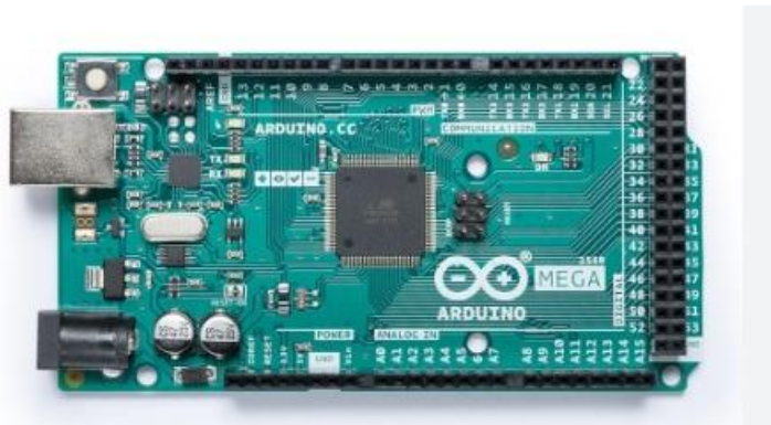
Şekil 5. İvmeölçer sensörlerden alınan verilerin işlenmesini ve kayıt altına alınmasını sağlayan Arduino Mega 2560 mikrodenetleyici kart.
