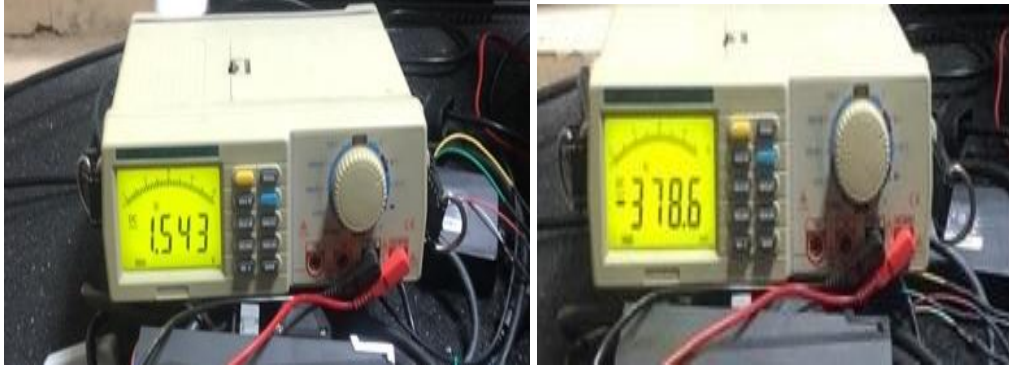
Şekil 23. a.) 20 saniye süren titreşim altında piezo sensörlerinden okunan maksimum volt değeri b.) Durgun halde piezo sensörlerinden okunan maksimum milivolt değeri
