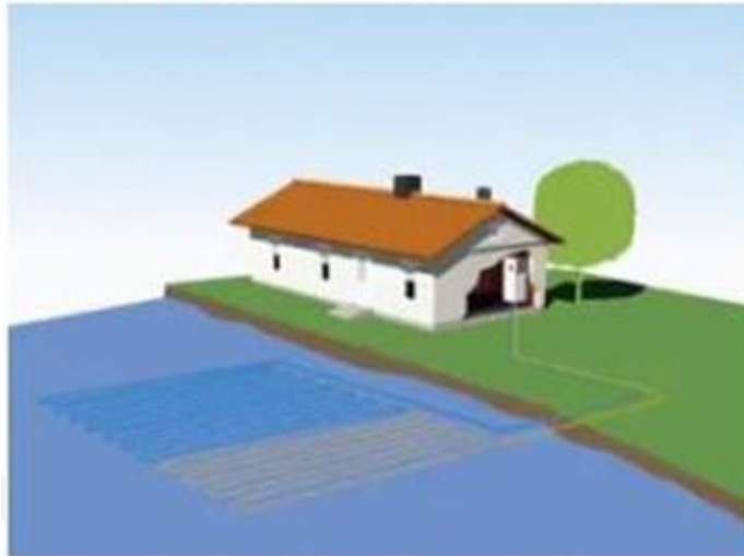
Şekil 9 Yer üstü suyu kaynaklı ısı pompası kullanımının gösterimi(Karabulut, 2024)
