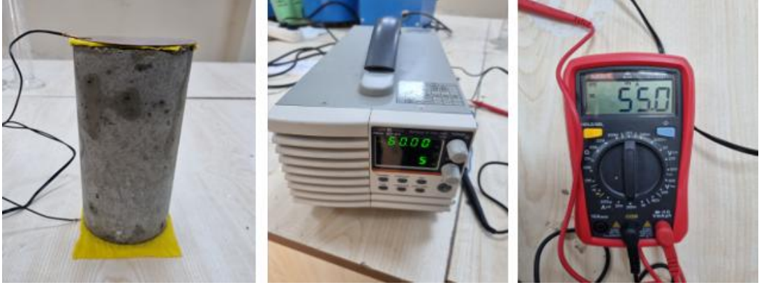
Şekil 3.13. Elektriksel özdirenç ölçümünde kullanılan ekipmanlar ve düzenek
