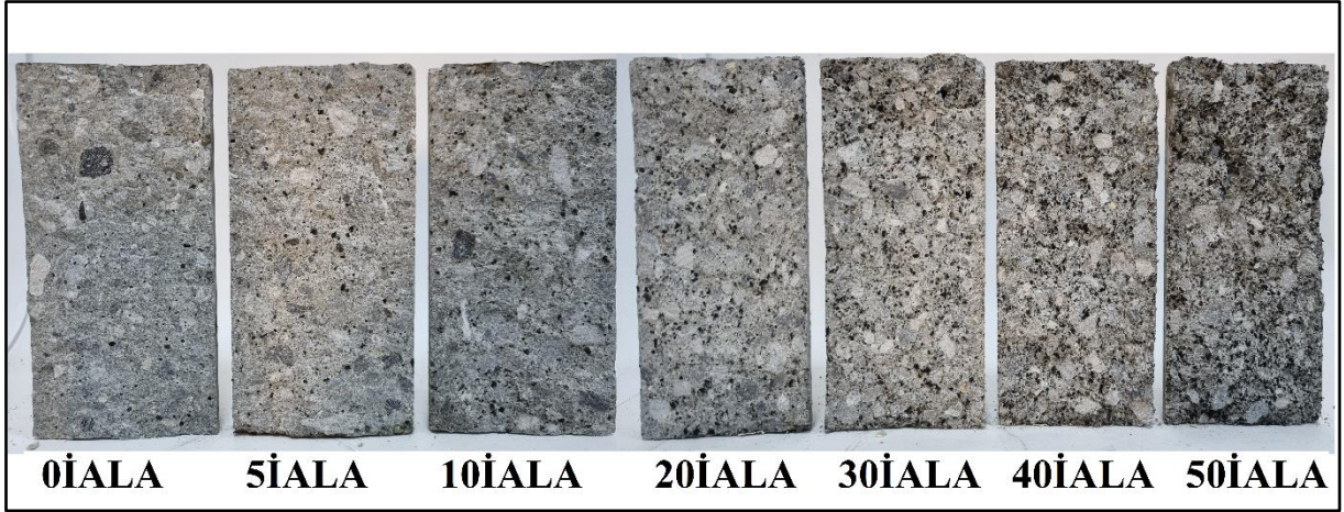
Şekil 5.4. Yarmada çekme deneyi testinde numunelerin yarılan yüzeylerinden alınan fotoğraflar.
