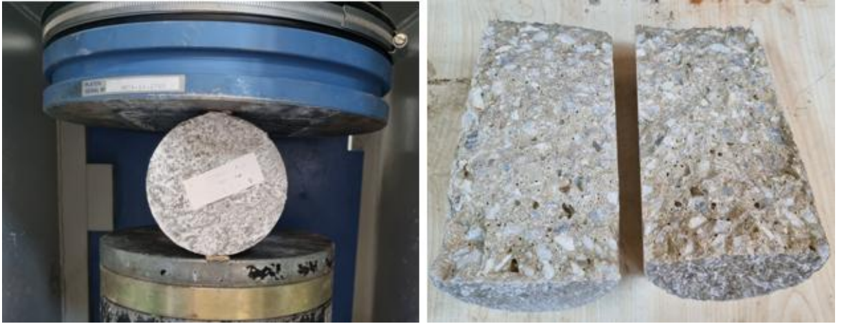
Şekil 3.12. Yarmada çekme dayanımı deney düzeneği (solda) ve yarılan numune (sağda)
