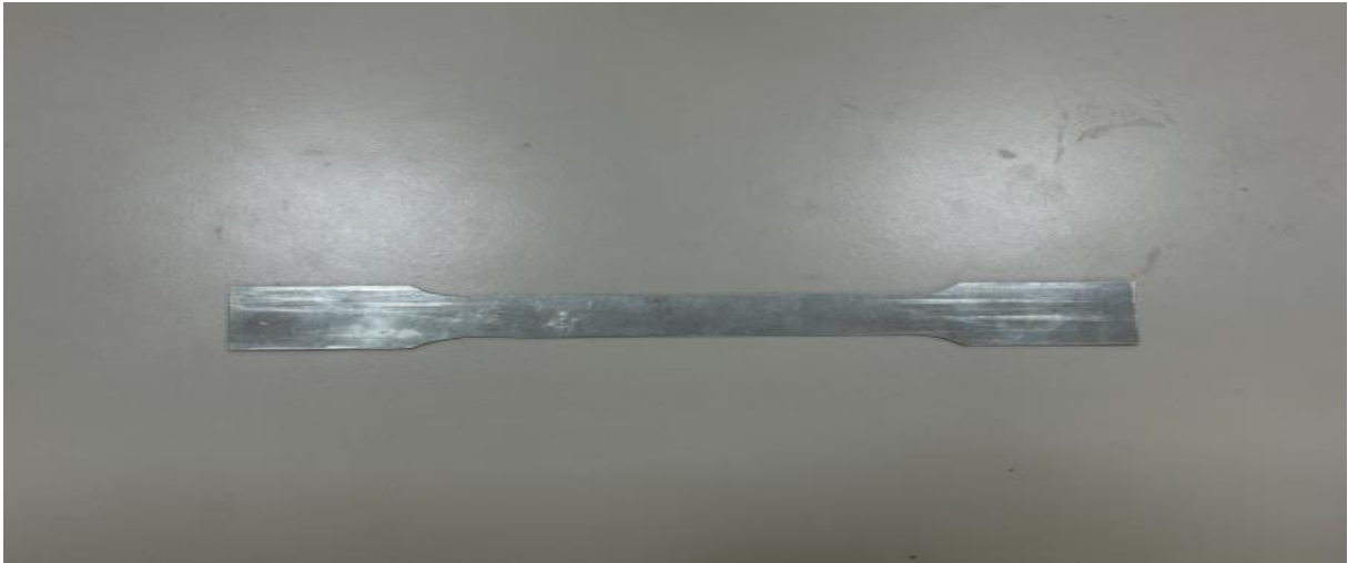
Şekil 17. ISO 6892 standardına göre hazırlanan örnek çekme numunesi
