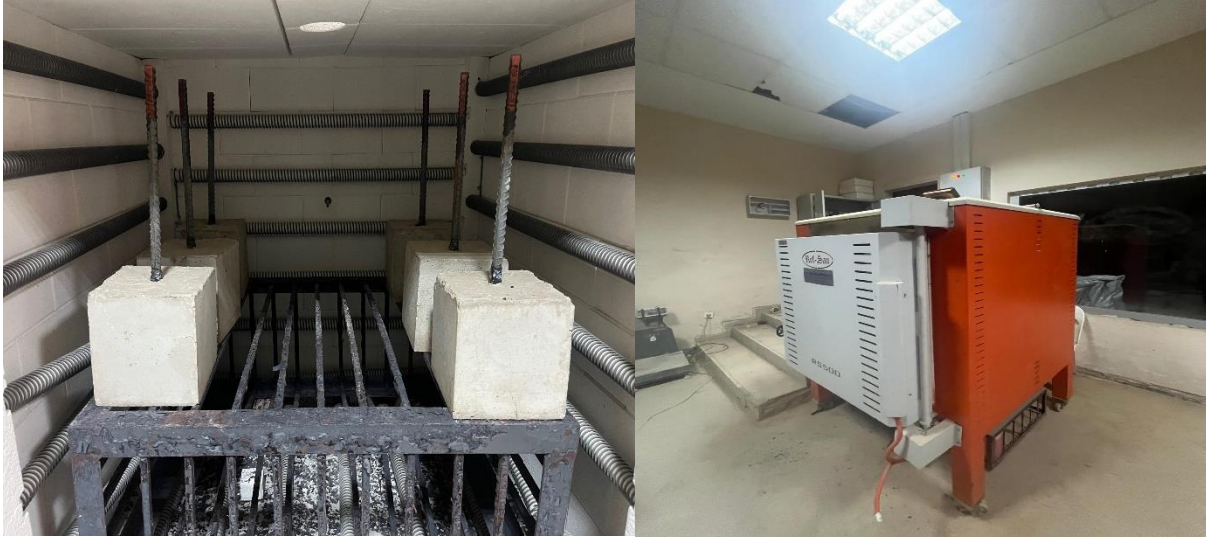
Şekil 3. 9. Yüksek sıcaklık deneyi için kullanılan fırın.
