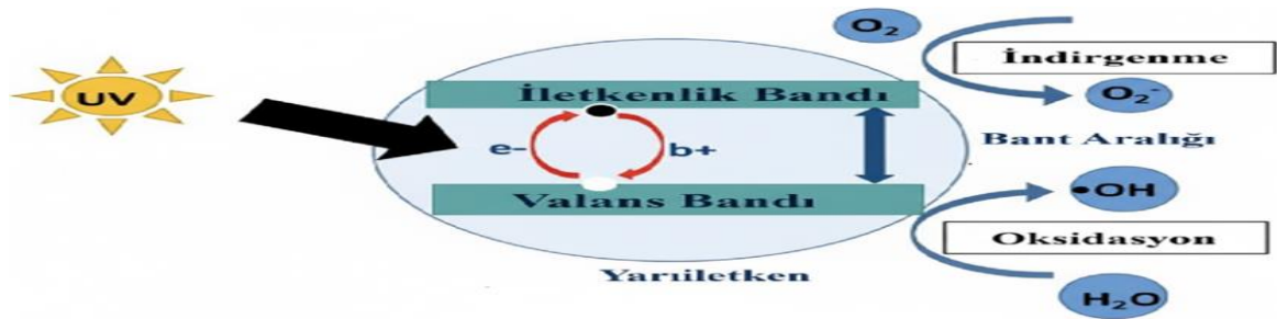
Şekil 1. Yarı iletken fotokataliz mekanizması (Burunkaya, 2012)
