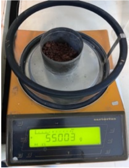
Şekil 3.15. Sıkıştırma öncesinde, 3 farklı kaptaki eşit ağırlıkta hazırlanan numuneler
