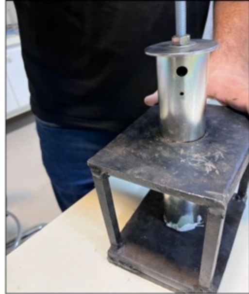
Şekil 3.16. Laboratuvar ortamında hazırlanan deney numunesi hazırlama aleti
