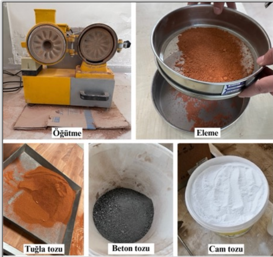
Şekil 3.4. Soldan sağa doğru İYA'nın öğütülmesi ve eleme işlemleri sonrası elde edilen tuğla, beton ve cam tozları
