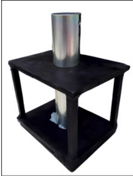
Şekil 3.16. Laboratuvar ortamında hazırlanan deney numunesi hazırlama aleti
