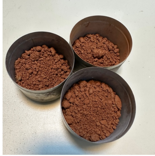
Şekil 3.15. Sıkıştırma öncesinde, 3 farklı kaptaki eşit ağırlıkta hazırlanan numuneler
