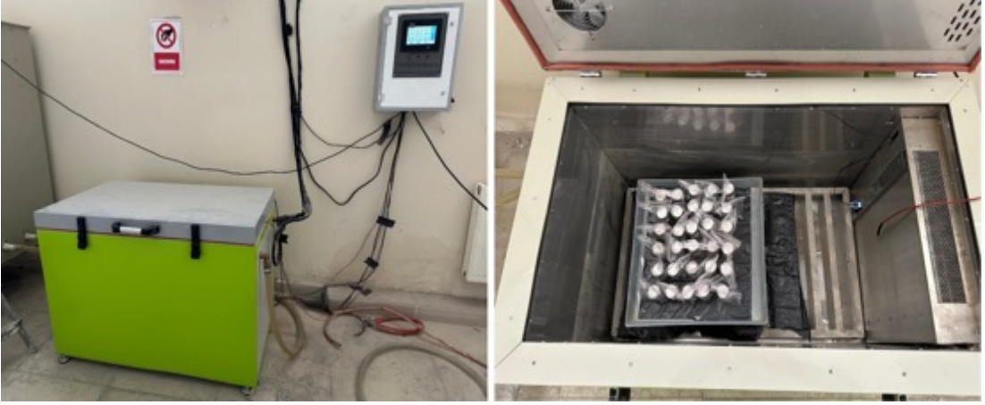
Şekil 3.20. Donma-çözülme cihazı ve donma-çözülme deney numuneleri
