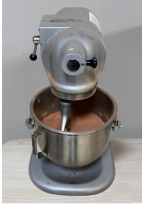
Şekil 3.12. İYA'dan elde edilen %60 tuğla tozu, %20 beton tozu ve %20 cam tozunun mekanik karıştırıcıda homojen şekilde karıştırılması işlemi.
