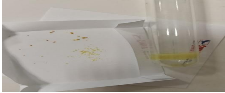
Şekil 23. Elüatlarda fiziki ayırım örnek görüntüsü
