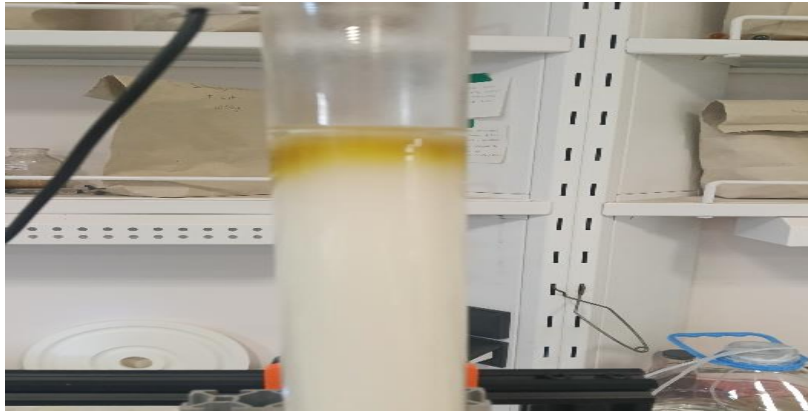
Şekil 22. Sefadeks kolon yürütme görüntüsü
