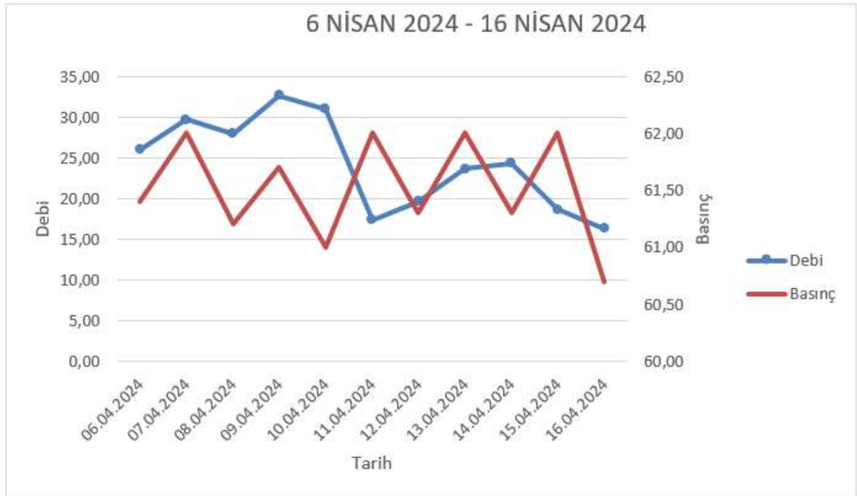
Şekil 24. 1. Bölge 06.04.2024 – 16.04.2024 tarihleri arası gece debisi/basınç grafiği
