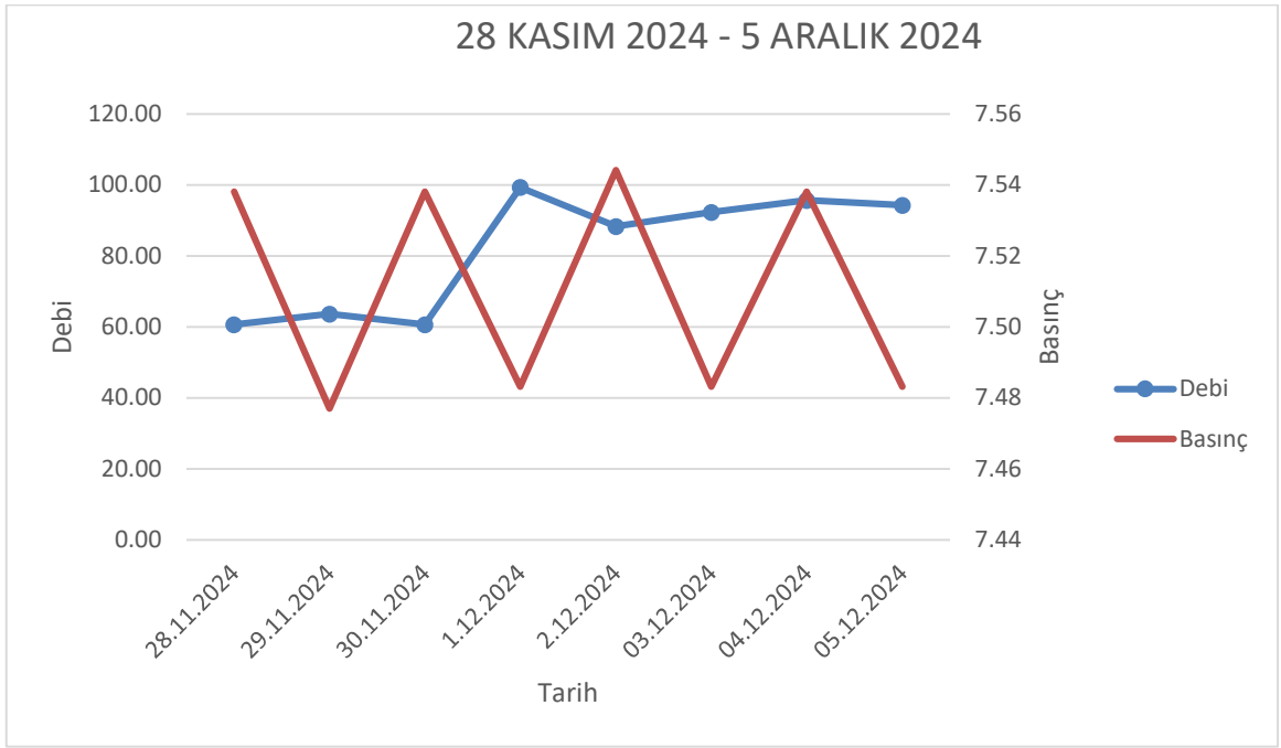
Şekil 51. 3. Bölge 28.11.2024 – 05.12.2024 tarihleri arası gece debisi/basınç grafiği
